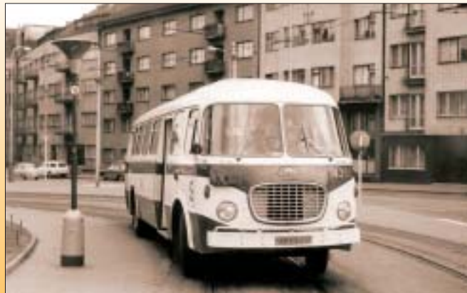
Městský autobus Škoda 706 RTO MEX (městský exportní) verze Kuba. Od jiných městských autobusů se lišily odsouvacím spodním dílem oken a mohutným nárazníkem podloženým gumou, který sloužil ke startování druhého autobusu roztláčením.
